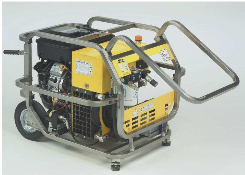
Das Hydraulikaggregat ist gemäß der EHTMA Kategorie E gebaut, die eine Leistung von max. 38 L/min bei 140 bar vorschreibt. Die Konstruktion ist mit einem offenem Zentrum. Ein Druckbegrenzungsventil ist im Hydraulikaggregat eingebaut, um einen zu hohen Druck zu vermeiden. Außerdem hat es eine sehr effektive Luftkühlung, die gegen Überhitzung sichert.
